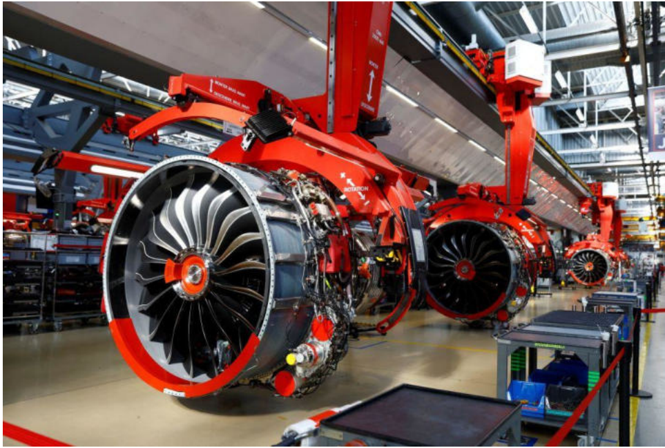
Figura 3: Línea de ensamblaje de motores aeronáuticos en planta de Safran Morocco
