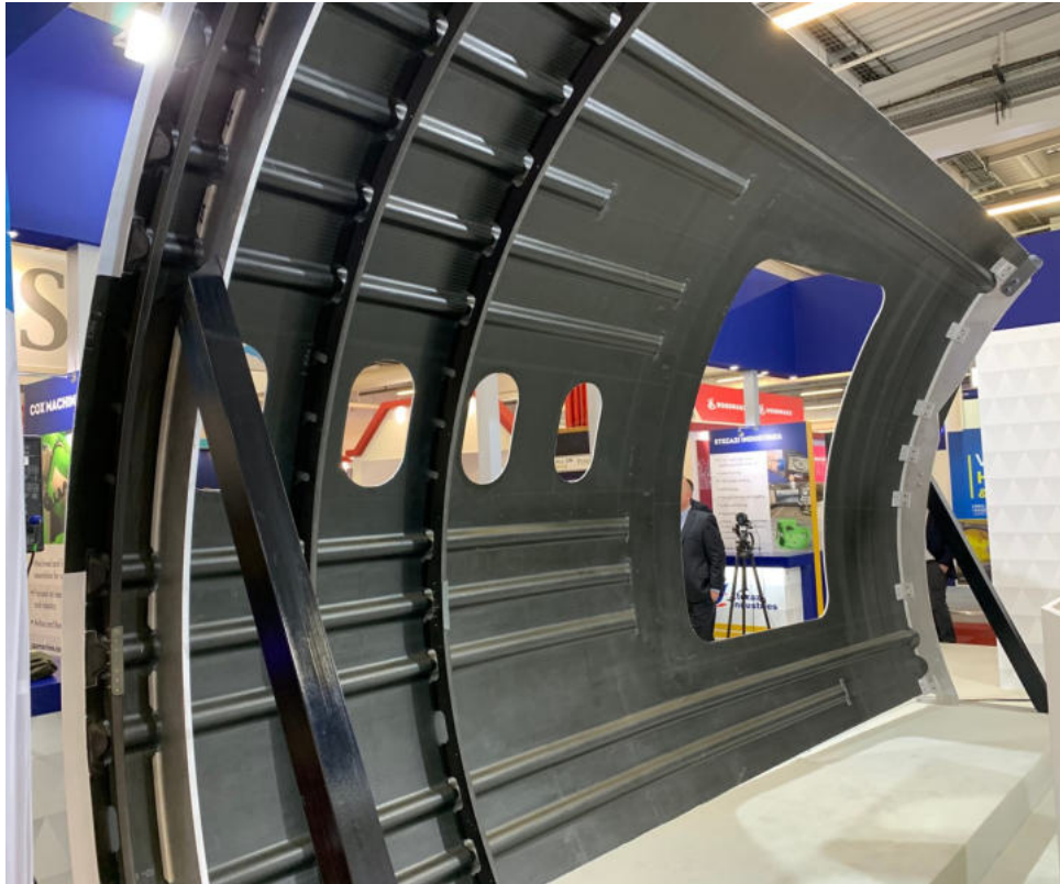
Figura 8: Estructura cilíndrica de fuselaje en material compuesto de alto rendimiento
